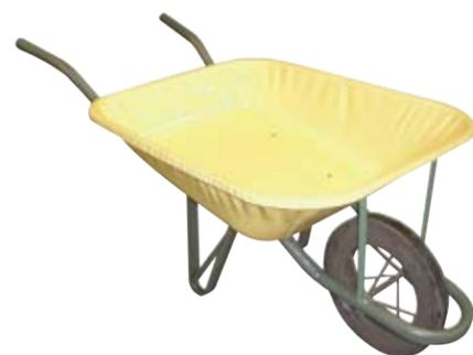
Carretillos Extra fuerte. Batea con capacidad de 64lts, en lamina de acero de 1.2mm. Batea montada sobre tubos de  $\pi$  en 1.8 mm. Patas en perfil y refuerzos traseros
