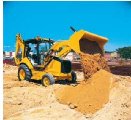
Las retroexcavadoras son ideales para instalaciones utilitarias como: zanjados, destapes, carga de vagonetas, limpieza de terrenos y otros.
