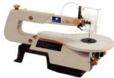
contorneadora DD-3000. Motor 120 watts (3/16 HP). Grosor de corte 50 mm. Velocidad de cuchilla: 500-1700 rpm.
