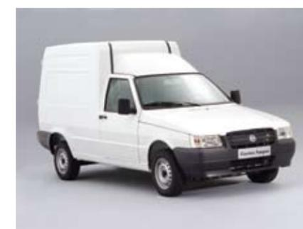
Fiat Fiorino Furgón, modelo 2009. Gasolina con motor FIRE 1.300 cc. 4 cilindros en línea, 8 válvulas. Gas LPG (Opcional). Transmisión manual de 5 velocidades. Sistema de frenos hidráulicos con disco delantero y tambor trasero. Capacidad de tanque de combustible 64 litros. Sistema de prevención de incendios (FPS). Llave codificada contra robo ( Fiat code). Equipo de audio con CD. Aros en acero estampado, neumáticos 165/70 R13. Longitud 4.184 mm. Ancho 1.622 mm. Alto vacío 1.873 mm.
