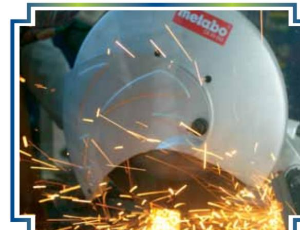
Tronzadora Metabo CS 23-255. 2300 Vatios y de 355 mm. Para metal, ajustable 15 y 45 grados.
