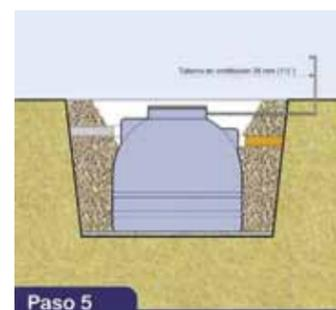
Coloque la tubería de conexión respectiva, según el uso que se le vaya a dar al tanque (fosa séptica o sistema). Además, instale en la parte superior del tanque una tubería de ventilación de unos 38 mm (1 1/2) de diámetro como mínimo y ubique la salida hacia el exterior tomando las precauciones para que no vaya a obstruirse.
