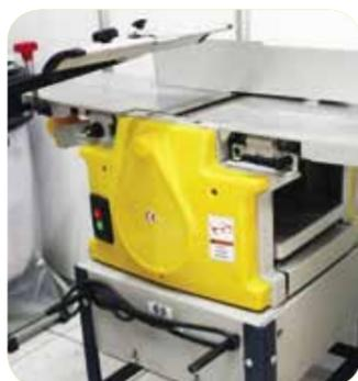
Canteadora cepilladora. Motor 2Hp, 110 Voltios. Especialmente, para marcos de 1" X 4" y 1" X 6" en madera suave. Marca Total Tools.
