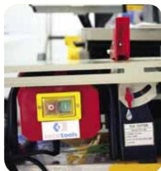
Cortadora de cerámica eléctrica 110 Voltios, 500 Wats. Para cortar en húmedo. Diámetros de cerámica hasta 40 cm. Marca Total Tools.
