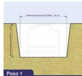
Excavar un hoyo con las dimensiones del tanque ECOTANK, dejando un mínimo de espacio de 30 cm., alrededor del mismo en la base del hoyo y 10 cm más de profundidad.
