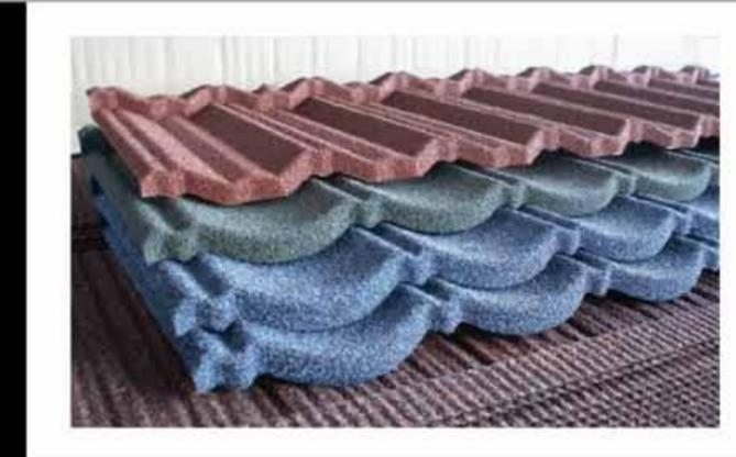
**Tejas Decra:** cubiertas para techo que se componen de un alma de acero estructural ultraliviano (7 kg/m<sup>2</sup>), recubierto de aluminio en su cara superior e inferior. Cada placa cubre el espacio equivalente a 7 tejas tradicionales que al superponerse conforman una estructura extremadamente resistente. Se cuenta con todos los accesorios para la instalación: cumbres, botaguas y accesorios de fijación (clavos y tornillos que provee el sistema).
