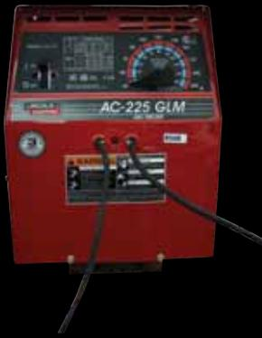
AC 225 GLM. Electrodo revestido, portátil. Capacidad de trabajo hasta electrodo 70-18 AC.
