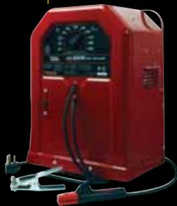
Soldadora modelo AC-225 para soldar acero dulce, aceros de baja aleación y acero inoxidable como también hierro fundido para reparaciones y proyectos hobby. Control escalonado de salida de 40-225 amps. CA suficiente para electrodos para acero dulce de 3/16" (4.8 mm) y electrodos seleccionados de 5/32" (4.0mm). Suelda lámina de metal calibre 16 a chapa gruesa de acero suave, acero inoxidable de baja aleación, hierro fundido y aplicaciones de revestimiento duro.
