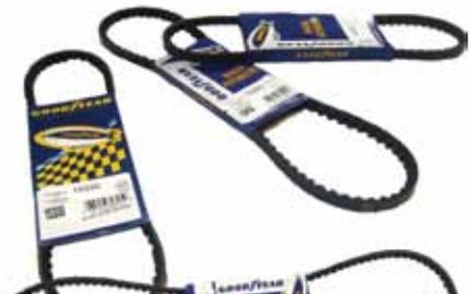
Fajas automotrices. De distribución, de alternador, de abanico y de dirección hidráulica. Fajas en medidas de 11 mm hasta 22 mm de ancho y de largo desde 24" hasta 76" de diámetro. En presentaciones de 3 canales a 10 canales, desde 19" hasta 100".
