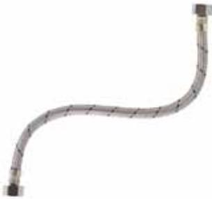
Conectores flexibles para agua. Modelo: AL-A40. Trenzado: Acero Inoxidable. Manguera interior: Hule EPDM. Espiga: Cobre o latón. Férua: Latón niquelado. Tuerca: latón niquelado o termoplástico de alta densidad. Temperatura de trabajo: 0° a 65° C. Presión máxima de trabajo: 8.8 kg/cm2 / 125 psi. Garantía: 10 años. Para instalar en lavatorios o fregaderos.
