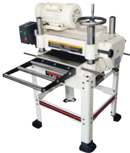
Cepilladora JET 13", 16" y 20", en potencias de 1.5HP a 3HP, alimentación 230V monofásico, construcción en acero y hierro fundido, caja de cambios de dos velocidades, cabezal de corte con tres cuchillas de acero de alta velocidad, rodillos de desplazamiento en ambos lados, toma de aspirado para colector de polvo en 4".
