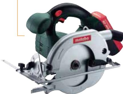
Sierra circular portátil 165 mm a batería 18V. Metabo. Hoja de sierra de metal duro. Fácil cambio de hoja gracias al bloqueo del husillo de trabajo. Placa guía completamente cerrada rodeando la máquina para un apoyo seguro. Indicador de corte visible y ajustable con precisión para serrar según trazado previo.
