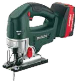
Sierra caladora con batería. 18 V,, Corta madera 135 mm. Metal NF 35mm. Cambio "Quick" de la hoja de sierra sin necesidad de herramientas. Electrónica variespeed (v) para la modificación continua del número de revoluciones. Sistema de control multifuncional para la protección de máquina y batería.
