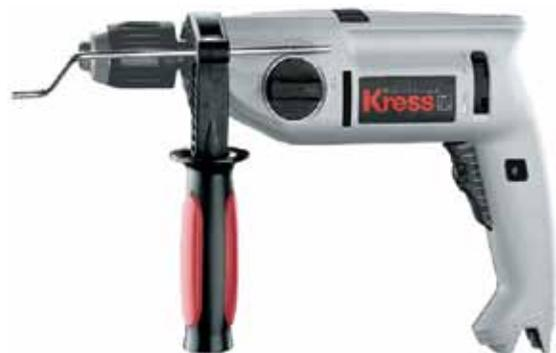
Taladro de percusión. Engranaje de dos velocidades. Portabrocas de fijación rápida de 13 mm de diámetro. Resistente a los impactos. Control electrónico y preselección de velocidad. Embrague de fricción de seguridad. Marca Kress. Alemania. 850 Vatios.
