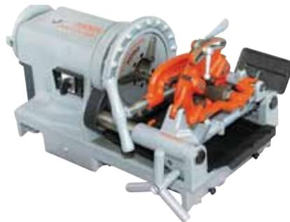
Motor Universal de 1/2 HP, 115V, 50/60Hz. Control del motor interruptor giratorio de alta resistencia avance/apagado/retroceso con interruptor integrado de pie. Velocidad del eje 38 RPM (disponible de 52 RPM). Portabroca tipo martillo con insertos para mordaza desmontable con acción basculante.
