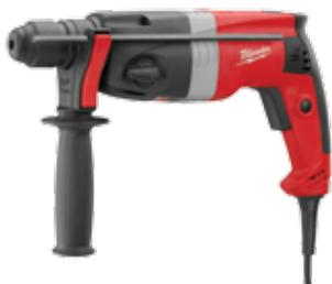
Rotomartillo Milwaukee 7/8". Compacto. Motor de 6.4 Amp, y 670 Watt. 0-1,290 RPM, 0-3,700 GPM. Fuerza de Impacto-2.7J de energía para perforar concretos fuertes. Operacion de 2 modos – Selector de taladro o rotomartillo.
