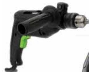
Taladro percutor. 120 V - 60 Hz. 6.3 Amperios. Shock 1/2". Reversa. Velocidad variable: 0 - 2800 RPM. 44800 / m.
