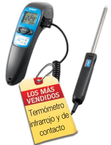
Rango de medición de temperatura por infrarrojos de  $-60$  a  $+625$  °C ( $-76$  a  $+1.157$  °F). Rango de medición de temperatura de contacto de  $-64$  a  $+1.400$  °C ( $-83$  a  $+1.999$  °F). Proporción distancia-al-punto 16:1; Emisividad variable por el usuario entre 0,1 y 1,0; Se proporciona una sonda de temperatura TMDT 2-30 (máx. 900 °C).
