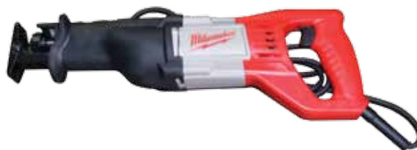
Sierra Sawzall. Amperios 12 .0. Longitud de la carrera 1-1/8". No SPM carga 0-3,000. Longitud 19". La protección de engranajes embrague: extiende la marcha y la vida del motor mediante la absorción de fuerzas de alto impacto causado por los calabozos de la hoja. QUIK-LOK™ abrazadera de la hoja: proporciona acceso rápido, sin herramientas cambio de la hoja.
