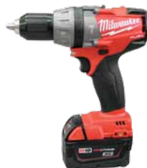
Taladro percutor inalámbrico. Voltios 18V. Esfuerzo de torsión 725 en libras. RPM 0-550 / 0-1,850 RPM BPM 31.450 BPM. Chuck Tipo 1/2" solo metal.
