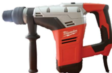
Rotomartillo SDS MAX. Voltaje: 120 V CA. Amperios: 10,5. Capacidad máxima de broca: 1-9/16". 450 RPM. 3000 BPM. Modos: rotomartillo y martillo sólo. Modelo: 5317-21.
