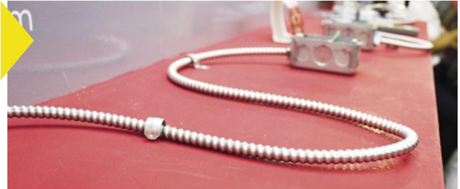
Cable Armorflex tipo MC, multiconductor con cables tipo THHN/THWN-2 cableados con 2, 3 ó 4 conductores de línea más un conductor para realizar las conexiones a tierra (calibres 12, 10, 8 y 6 AWG). El conjunto de los cables lleva una cubierta metálica engargolada de aluminio, que brinda la protección mecánica al conjunto. Este cable está certificado bajo norma UL-1569 y está fabricado para operar hasta tensiones de 600 Vac, tal y como lo solicita el Código Eléctrico de Costa Rica (NEC NFPA-70).
